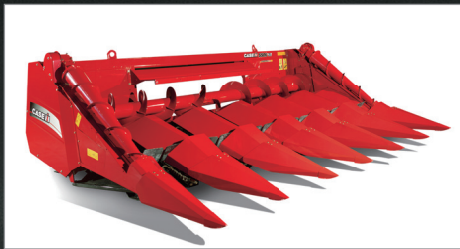
8 行 65 厘米行距玉米割台，可选配底刀； 8 行 50 厘米行距玉米割台 标配油浴自动润滑，可选配左右扶禾绞龙
