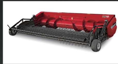
凯斯 3016 (15 英尺) 捡拾台 捡拾宽度 4.6 米，固定式仿形轮，机械式浮动 捡拾器，三段式传送带
